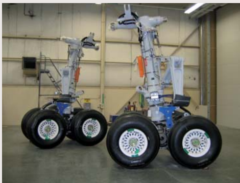
Elektrisch geremd en met kunststof 'braces'.
