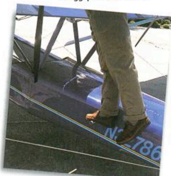
Het praktische opstapje voor de check van de beide hooggeplaatste motoren.
