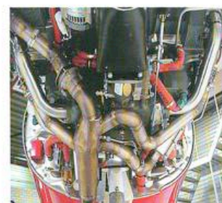
De onderzijde van de motor. Maatwerk leidt tot minder weerstand.
