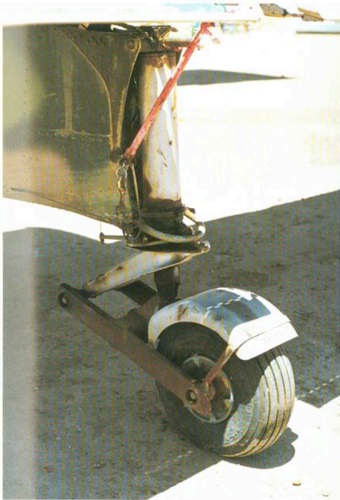
Het stevige staartwiel, voorzien van een fors uitgevallen spatbord, duidt op gebruik op onverharde (gravel)banen.
