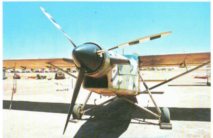
De vierkante inlaat zuigt zuurstof aan voor de krachtige PT-6 turbine.
