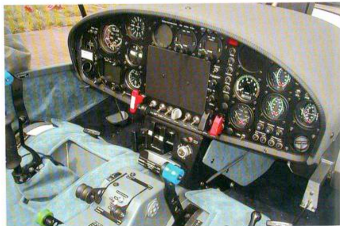
Opmerkelijk in de cockpit zijn de bedieningsorganen voor het uitschuiven van de neuskegel, onderaan op de middenconsole.
