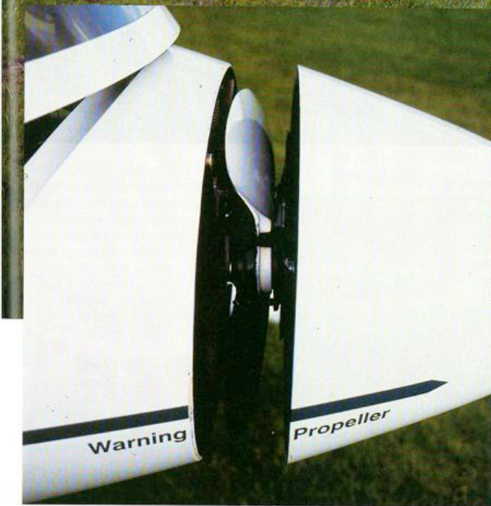
De propbladen komen door de centrifugaalkracht naar buiten.
