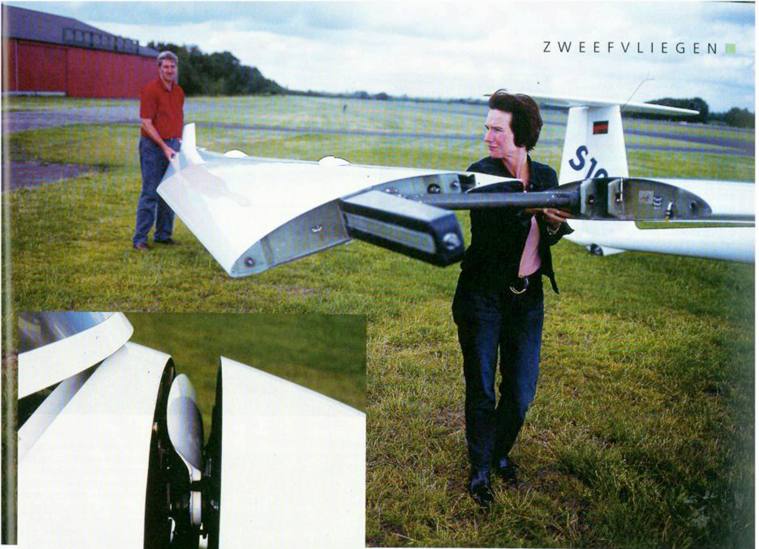
Door de zeer praktisch opvouwbare vleugels, die in de stalling op de romp liggen, is de Stemme makkelijk 'klein de stallen'. De spanwijdte wordt van 23 naar 11,5 meter gereduceerd.
