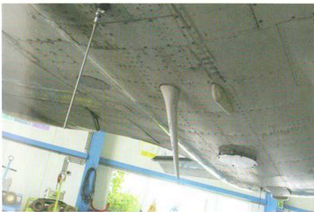
Vier van de vele antennes. Het ontvangstbereik van de voorste staafantenne heeft de bekende donut-vorm, de achterste schijfvormige antenne 'vult het gat'.
