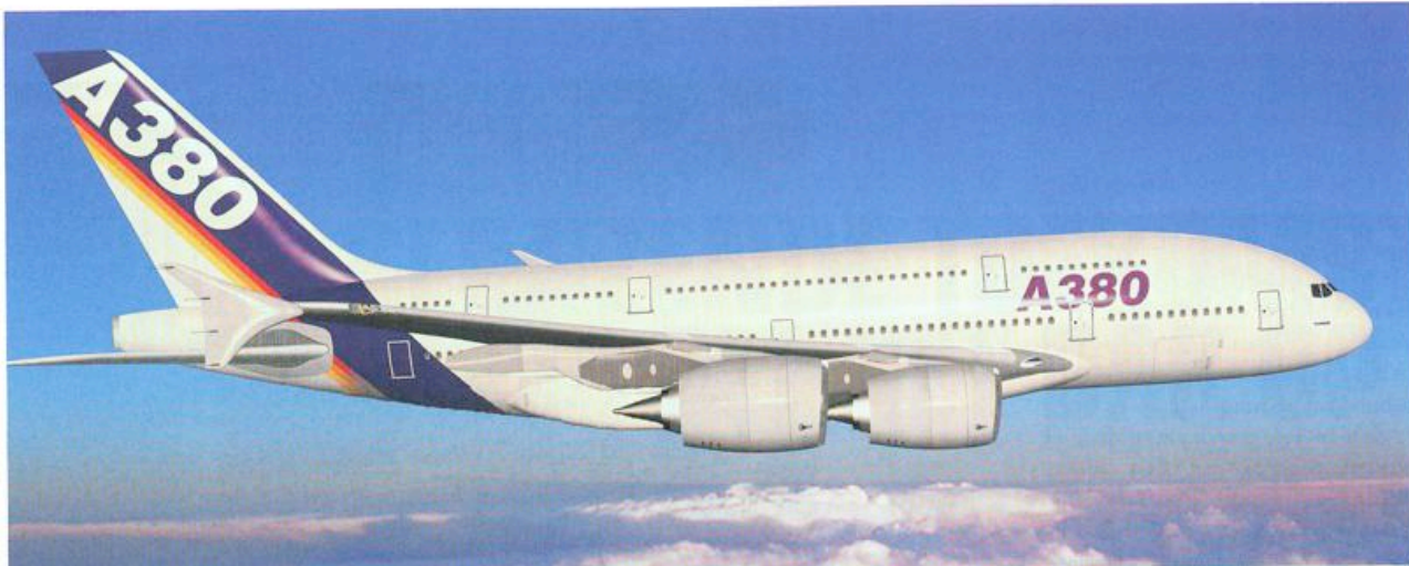
Bij de bouw van elke A380 wordt zo'n 450 m 3 Glare toegepast.
