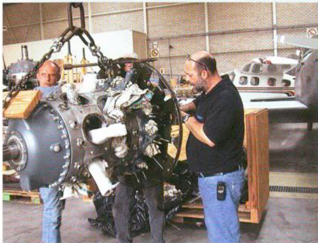
1 Getest tot tevredenheid: Theo Hendriks en hoofd-TD Chiel van de Pijl. 2 De zingende tandarts kennen we, maar een buschauffeur die aan bommenwerpers sleutelt is toch even wat anders. 3 Negen weken sleutelen: de gereviseerde crankcase wordt weer 'gevuld' met de inmiddels in eigen beheer opgeknapte cilinders en bewegende delen. 4 Kleppen slijpen, cilinders honen, klepzittingen leppen: deze motor heeft inmiddels alweer 150 uur gedraaid.
