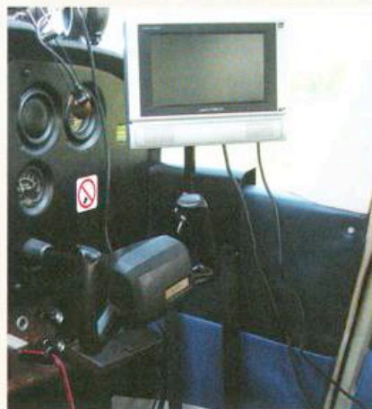
De videomonitor, om tijdens de vlucht de gemaakte opnamen te kunnen checken.
