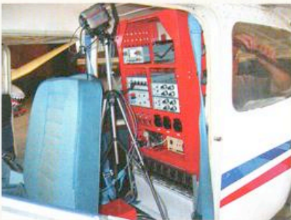
Het flighttest instrumentation-rack met o.a. straingauge-versterkers, (backup)-powersupply, plus differential en offset amplifiers. Op de grond de attitude-gyro, een achtkanaals thermische printer (ex-Fokker) met tijdsynchronisatie en opnamenummer. Verder een Sony digitale videorecorder (op cd) en een oscilloscoopje.
