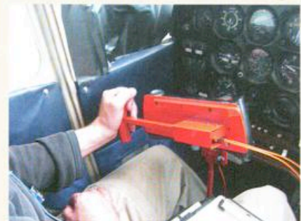
Een foto tijdens de testvlucht. Donkere kleding moet reflecties in de instrumentglazen voorkomen. Met het 'meetstuur' worden de pitch- en rollkrachten gemeten die (via de oranje ex-Fokker-bekabeling) versterkt worden door straingauge amplifiers.
