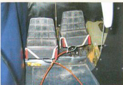
De druksensoren met zgn. 'straingauges' om de pedaalcrachten te meten en registreren.
