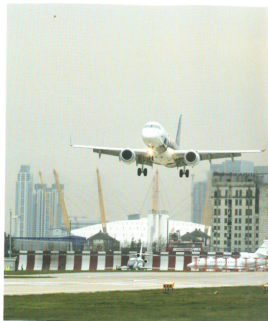
Ooit eisten de Engelse autoriteiten een supersteile naderingshoek van 7,5 graden, tegenwoordig is dat 5,5. De naderingshoek voor een 'normaal' vliegveld is 3,1 graden.
