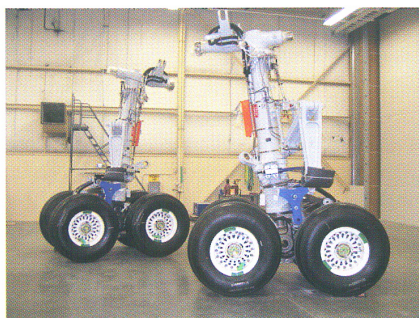
Elektrisch geremd en met kunststof 'braces'.
