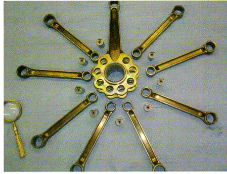
Met reden: oneven aantal cilinders.
